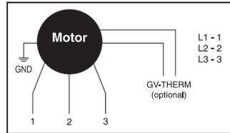
4. Encienda la corriente al motor preñdiendo (ON) y apagando (OFF), (no más de 0.5 segundos en la posición de encendido (ON)). Si el motor da vuelta, entonces la conexión está correcta y puede proceder al Paso 5. Si el motor no da vuelta, intercambie cualquiera de los dos cables de entrada de corriente.
